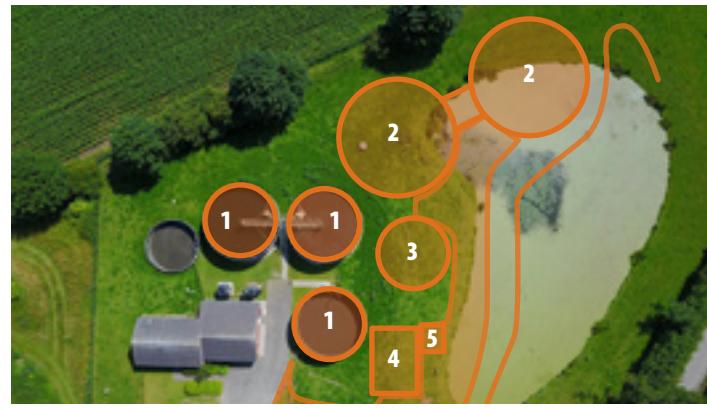
▲ Großbaustelle 2023 auf der Kläranlage Freienwill. Drei vorhandene Anlagen (1) werden zu Schlammspeichern umgenutzt. Die Biologische Reinigungsstufe entsteht neu (2), ebenso wie ein Vorlagebehälter (3), ein Technikraum (4) und eine Fällmittelstation (5). Der Schönungssteich wird in dem Zuge verkleinert. Montage: SPREE-PR
